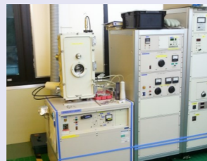
真空蒸着装置 真空中にて材料を加熱(抵抗 加熱・電子ビーム加熱)する ことにより成膜が可能
