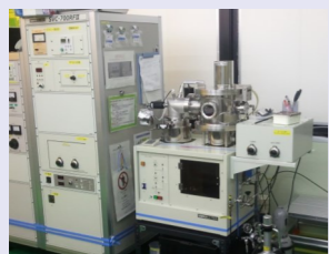
スパッタリング装置 イオンによるスパッタリン グ現象を利用し、金属膜や 絶縁膜の成膜が可能
