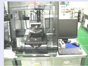
触針式表面形状測定器 オンゲストロームオーダー の段差が測定可能
