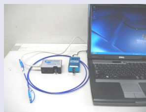
ファイバマルチチャンネル 分光器 波長200nmから1100nmまでの 分光測定が可能
