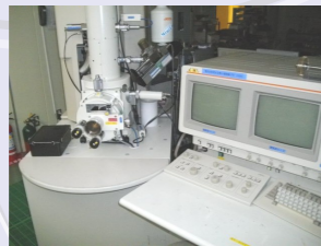
電界放射型走査電子顕微鏡 (FE-SEM) 高分解能電子顕微鏡観察が 可能
