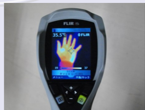
赤外線サーモグラフィ 試料表面温度を画像として 測定可能。測定温度範囲は 0から250℃
