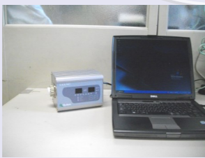
残留ガス分析計 質量数範囲は1から100で、プ ロセスガスモニターやリークテ スターとしても使用可能
