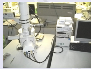
電子ビーム露光装置 試料への直接描画やフォト マスクの製作が可能
