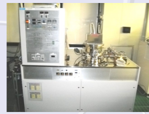
プラズマCVD (Chemical Vapor Deposition)装置 TEOSを材料とし、SiO 2 の成 膜が可能
