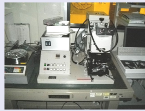
マスクアライナ フォトマスクと試料の位置合 わせが可能 密着露光式
