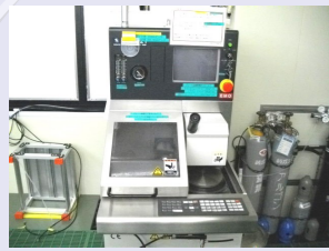
ダイシングソー 高速回転のブレードにより 試料の切断が可能
