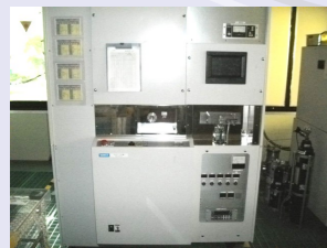
反応性イオンエッチング 装置(RIE) SF 6 , CHF 3 , O 2 , CF 4 , Ar, Krによるエッチングが可能
