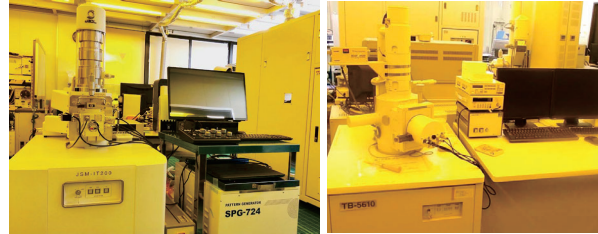
電子ビーム露光装置 サンユー電子 (SPG-724), 東京テクノロジー (TB-5610)
