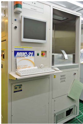
Deep-RIE 装置 (SPP テクノロジーズ) SF 6 , C 4 F 8 , O 2 @メカノマイクロプロセス室
