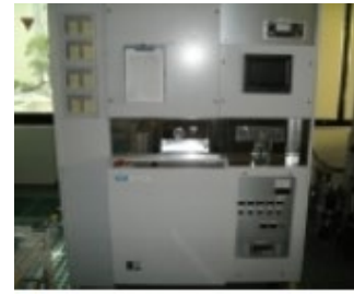
RIE 装置 (サムコ) SF 6 , CF 4 , CHF 3 , O 2 , Ar, Kr @メカノマイクロプロセス室
