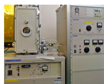
真空蒸着装置 (EB, 抵抗加熱) (サンユー電子) @メカノマイクロプロセス室
