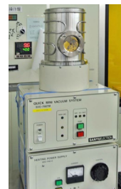
蒸着装置 (抵抗加熱) (サンユー電子) 金属用 @メカノマイクロプロセス室
