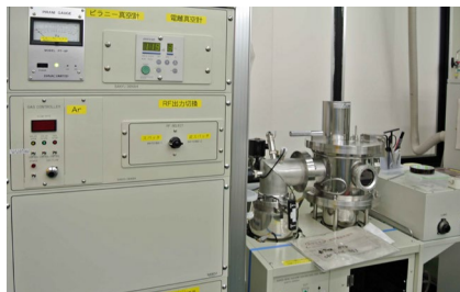
RF マグネトロンスパッタ装置 (サンユー電子) 金属・誘電体用 @メカノマイクロプロセス室
