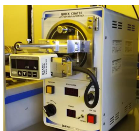
簡易スパッタ装置 (サンユー電子) エッチングマスク用 Cr @メカノマイクロプロセス室
