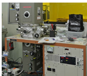
RF マグネトロンスパッタ装置 (キヤノンアネルバ) 金属・磁性体用 @メカノマイクロプロセス室
