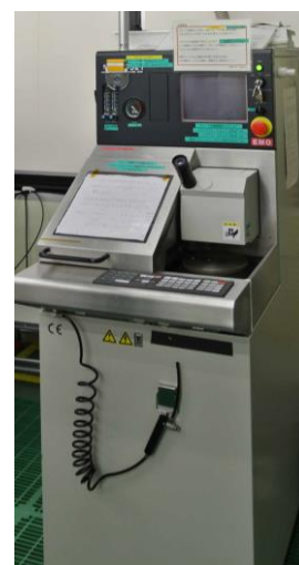
ダイシングソー (ディスコ) @メカノマイクロプロセス室 @メカノマイクロプロセス室 2
