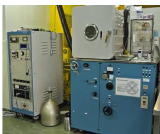
真空蒸着装置 (EB, 抵抗加熱) 金属用 @メカノマイクロプロセス室 2
