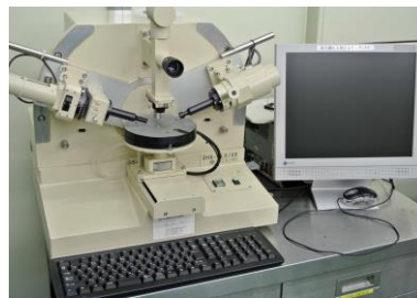
エリプソメトリー (溝尻光学) @メカノマイクロプロセス室
