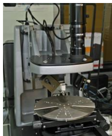
触針式表面形状測定機 (Veeco) @メカノマイクロプロセス室
