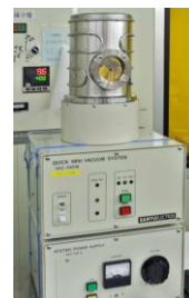
蒸着装置 (抵抗加熱) (サンヨー電子) 金属用 @メカノマイクロプロセス室
