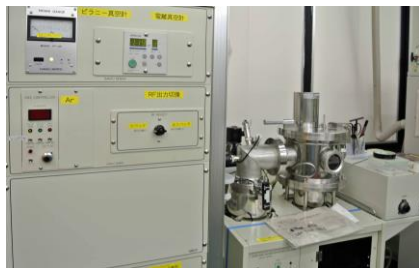
RF マグネトロンスパッタ装置 (サンヨー電子) 金属・誘電体用 @メカノマイクロプロセス室
