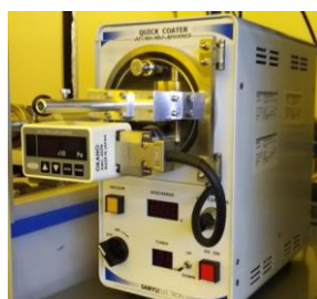
簡易スパッタ装置 (サンヨー電子) エッチングマスク用 Cr @メカノマイクロプロセス室
