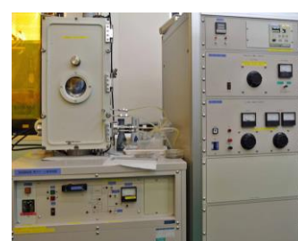
真空蒸着装置 (EB, 抵抗加熱) (サンヨー電子) @メカノマイクロプロセス室
