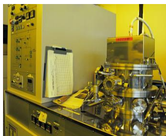
プラズマ CVD 装置 (サムコ) TEOS による SiO 2 の成膜 @メカノマイクロプロセス室
