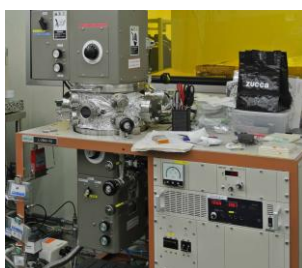
RF マグネトロンスパッタ装置 (キヤノンアネルバ) 金属・磁性体用 @メカノマイクロプロセス室
