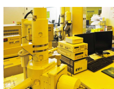
【リソグラフィ】 EB露光装置 (東京テクノロジー)
