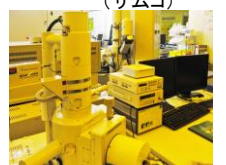
【リソグラフィ】 EB露光装置 (東京テクノロジー)
