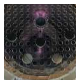
図 6 図 4(d)の磁石配置での \text{H}_2\text{O} プラズマ放電
