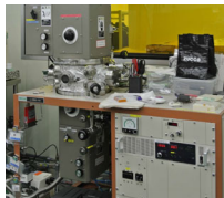
【成膜】 スパッタ装置 (キヤノンアネルバ)
