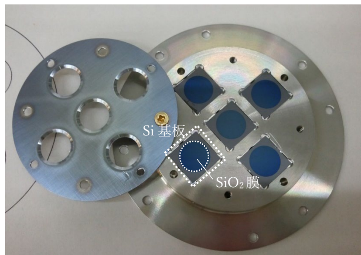
図 4-11 作製した治具および Si 基板に成膜した写真
