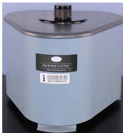
図2-11) 新規導入された 160°Cまで測定可能な DSC
