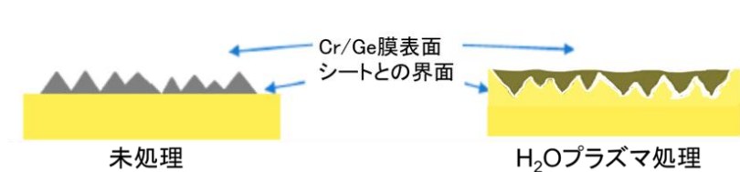
(b) Cr/Ge 成膜後のポリイミドシートの断面モデル
