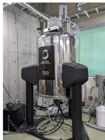
図 1-2-3 日本電子社製 JNM-ECZ700R 700MHz 溶液 NMR 装置
