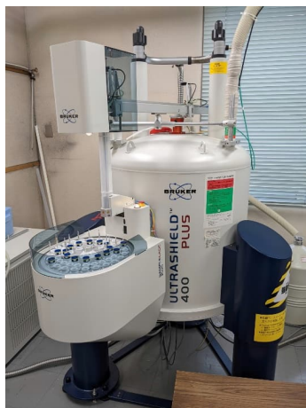
図 1-2-1 Bruker 社製 AVANCEIII Nanobay 400MHz 溶液 NMR 装置
