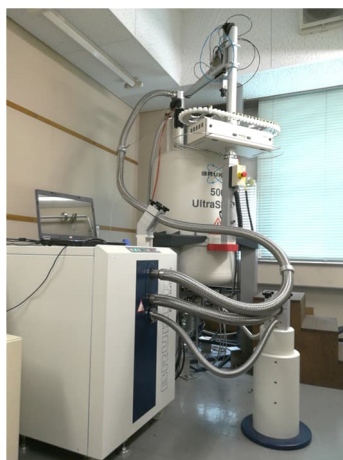
図 1-2-2 Bruker 社製 AVANCEIII CryoProbe 500MHz 溶液 NMR 装置
