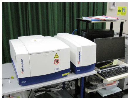
図 1-2-5 Bruker 社製 プロトンパルス NMR 装置
