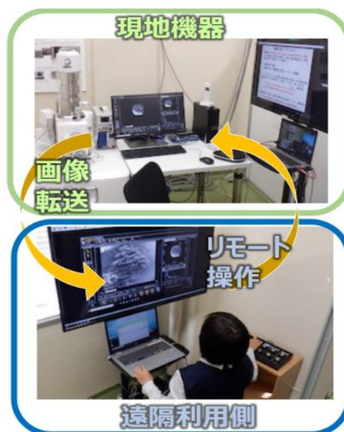
図 4.2-1 完全遠隔利用の説明図
