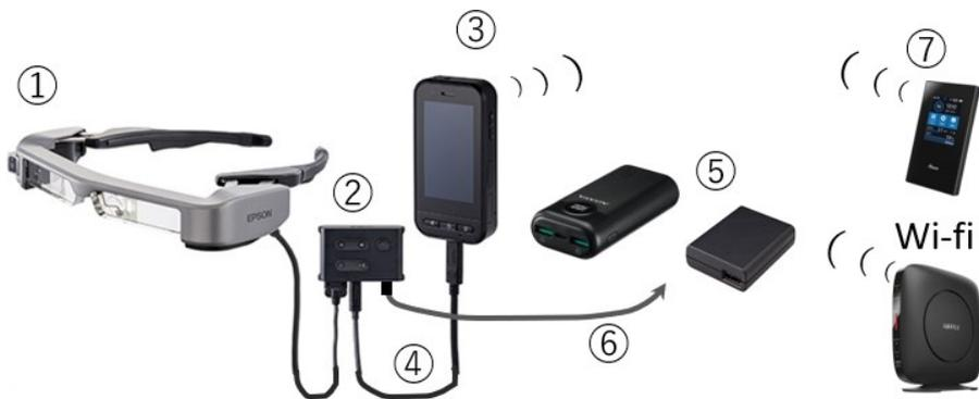
図 2.3-4 EPSON 社製 MOVERIO/BT-35ES スマートグラス一式 (①スマートグラス、②インターフェイスボックス、③BO-IC 400 (インテリジェントコントローラー)、④USB ケーブル、⑤電源：モバイルバッテリー or AC アダプター)、⑥電源用 USB ケーブル、⑦モバイルルーター or Wi-Fi)
